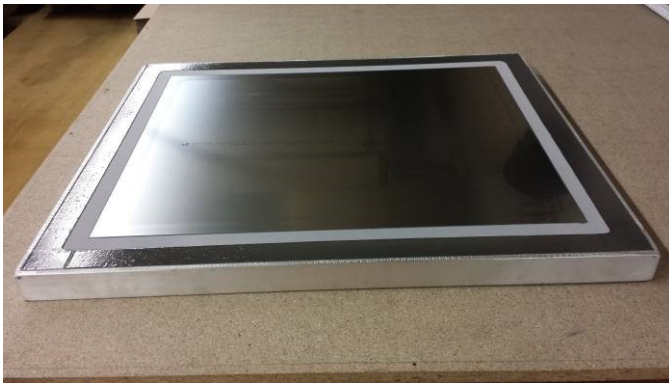
Bild 1: Schablone auf Siebgewebe im Rahmen gespannt, ohne Siebfüller
